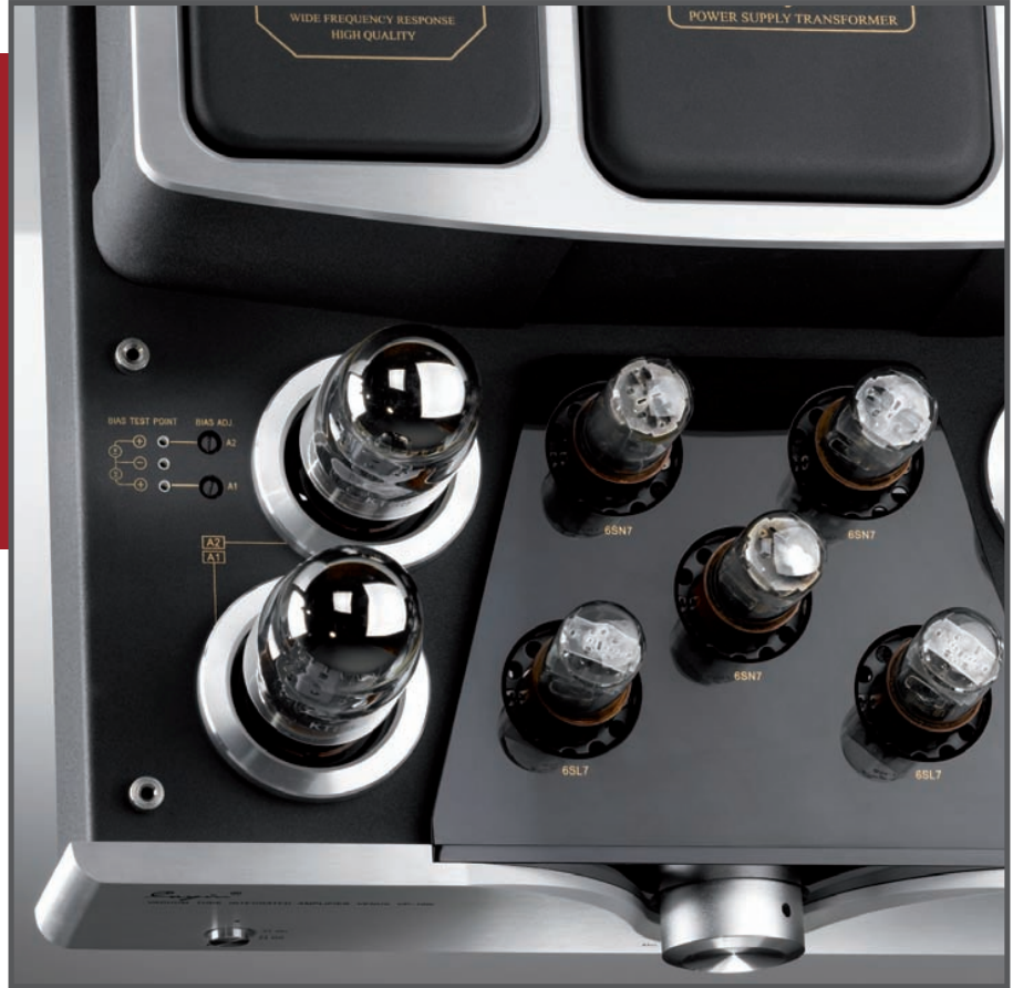
Mit Abgriffen für ein Voltmeter und von außen zugänglichen Stell-schrauben neben den pro Kanal zwei KT88-Endröhren (links) lässt sich der Bias des Cayin anpassen.
